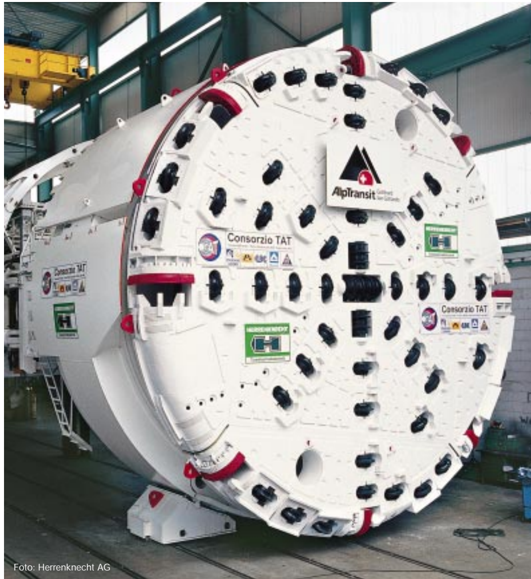
Tunnelbohranlage der Herrenknecht AG, Bohrkopf (Durchmesser 8,83 m), ein Beispiel für den Einsatz von Brennzuschnitten
